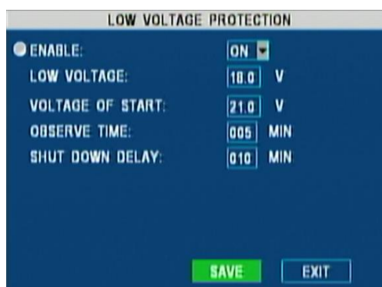
Protección de baja tensión: Figura 46
